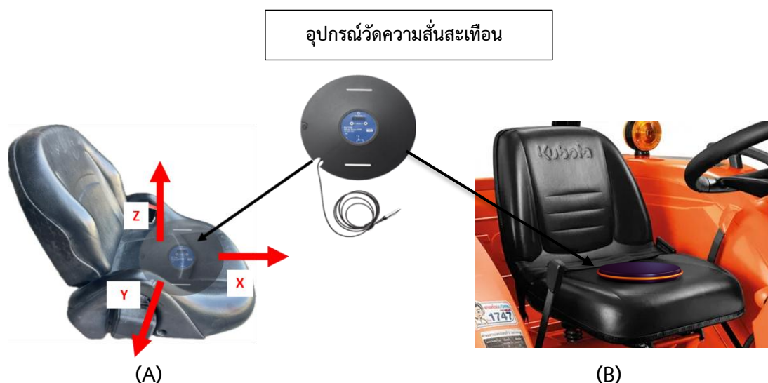
ภาพที่ 3.7 การติดตั้งอุปกรณ์วัดความสั่นสะเทือนทั่วร่างกาย
