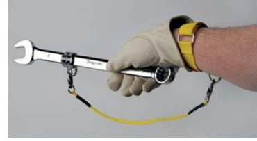
การใช้เชือกป้องกันอุปกรณ์การทำงานหล่น
