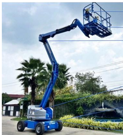
รถกระเช้าบูมลิฟท์ (Boom Lift)
