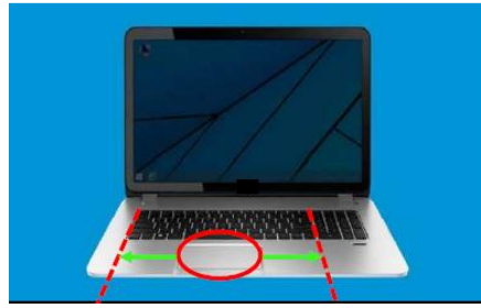
ภาพที่ 6 ตำแหน่งที่เหมาะสมของแผ่นสัมผัสบนส่วนฐานเครื่องคอมพิวเตอร์โน้ตบุ๊ก
