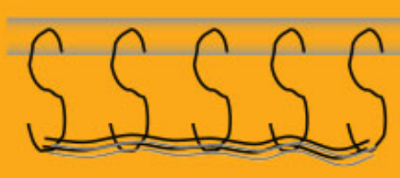
เดินสายใช้เสารูปตัวเอส
