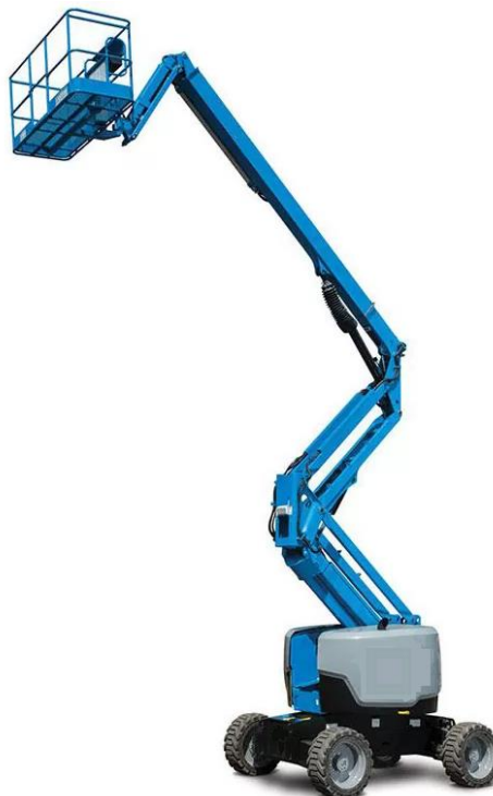
ภาพที่ 2-12 รถกระเช้าแบบแขนพับ (Articulated Lift)
