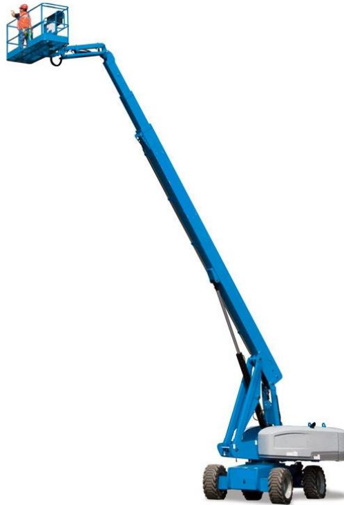
ภาพที่ 2-11 รถกระเช้าแบบแขนตรง (Telescopic Lift)
