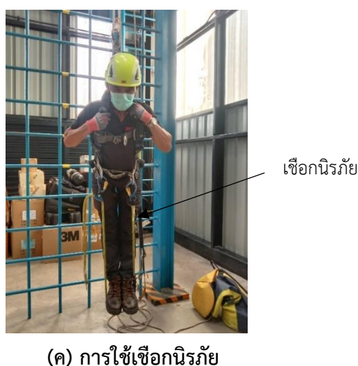
ภาพที่ 4-2 การใช้อุปกรณ์ช่วยพยุงตัวสำเร็จรูป (Suspension Trauma Strap) เชือก และเชือกนิรภัย
